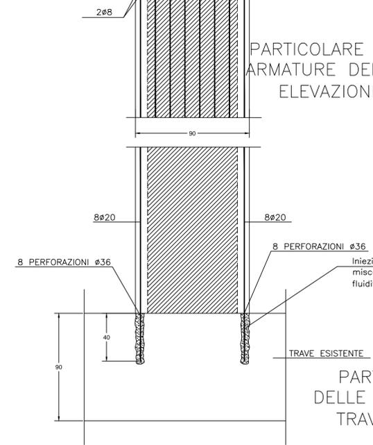
PARTICOLARE DEL COLLEGAMENTO DELLE ARMATURE DEL PILASTRO ALLE TRAVI DI FONDAZIONE (SEZ. X-X)
