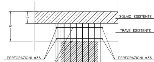
PARTICOLARE DEL COLLEGAMENTO DELLE ARMATURE DEL PILASTRO ALLE TRAVI IN ELEVAZIONE ESISTENTI (SEZ. Y-Y)
